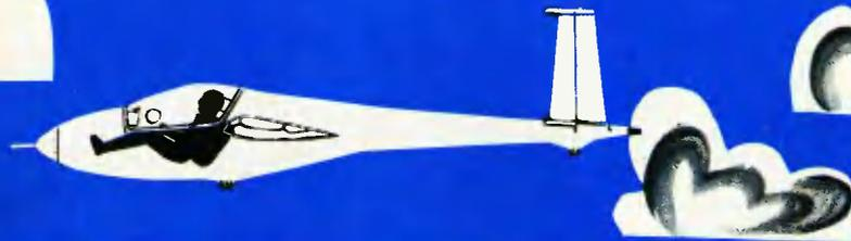
Это, по сути, тот же планер «Амур», та же технология, тот же вес, те же крылья... Впрочем, почти! Надо сказать, что крылья получили некоторое увеличение размаха за счет дополнительных небольших консолек на концах крыла. Фюзеляж же полностью изменен — сделан плавным, красивым (см. цв. рис. На фото — эпизоды первых Всесоюзных соревнований).
